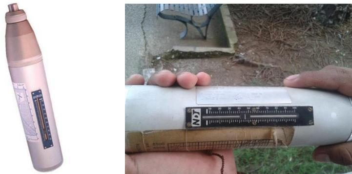
Figura 19 Esclerómetro mecánico.
