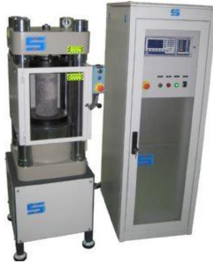
Figura 18 Máquina de compresión simple para hormigón.
