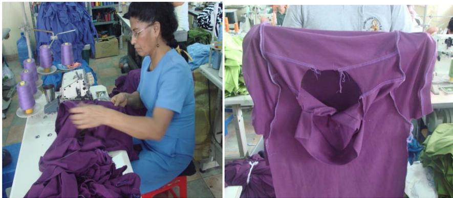
3) Coser Mangas con la máquina Overlock 5 Hilos.
