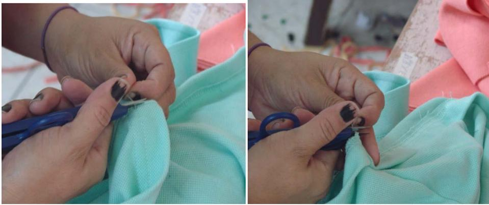
11) Pulido, en esta sección se inspecciona las prendas, se le corta el excedente de hilo y se califican para su venta.
