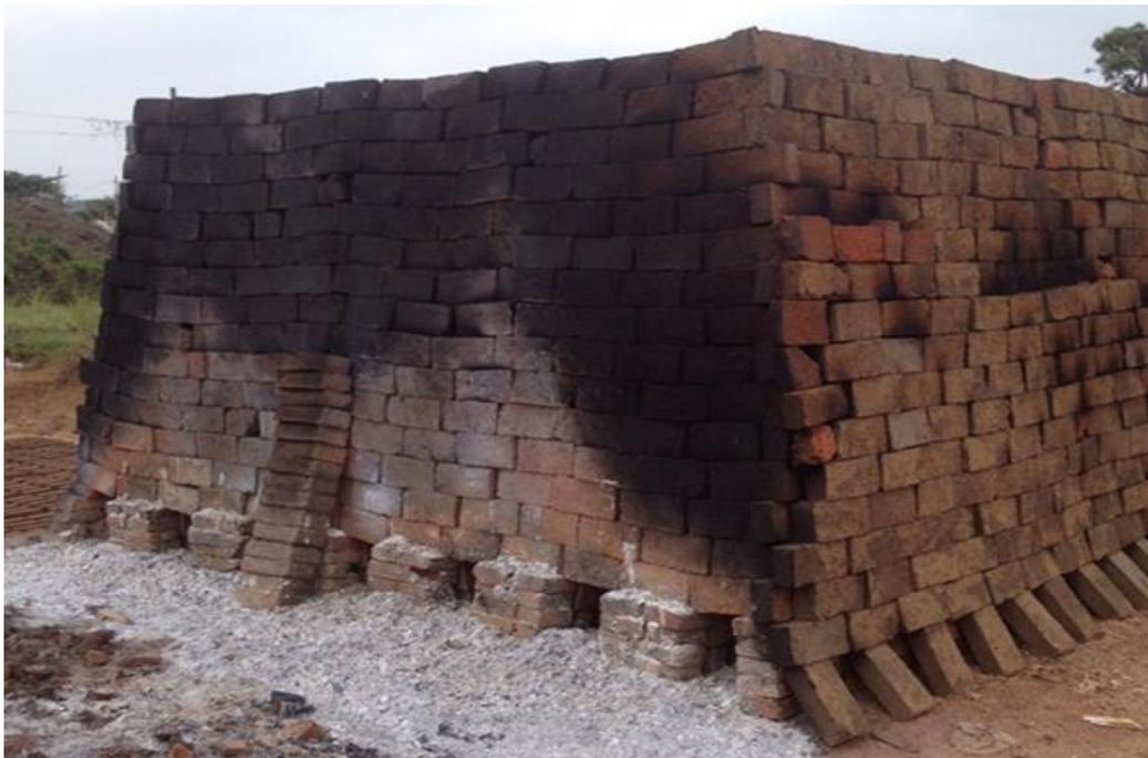
**Figura 3.21** Algunas muestras de ladrillos con diversas adiciones de lodos residuales después de la cocción.
