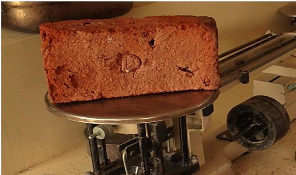
**Figura 3.24** Muestras de ladrillos con diversas adiciones de lodos residuales siendo ensayados.
