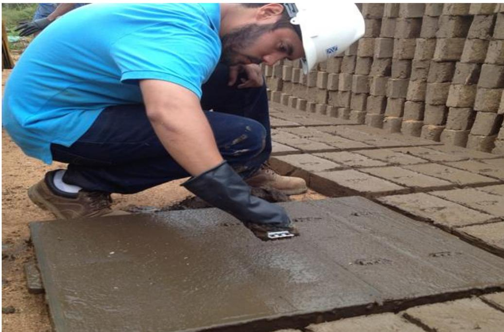
**Figura 3.14** Preparación de ladrillos, muestra “E”, con un contenido de 100% de lodos residuales.
