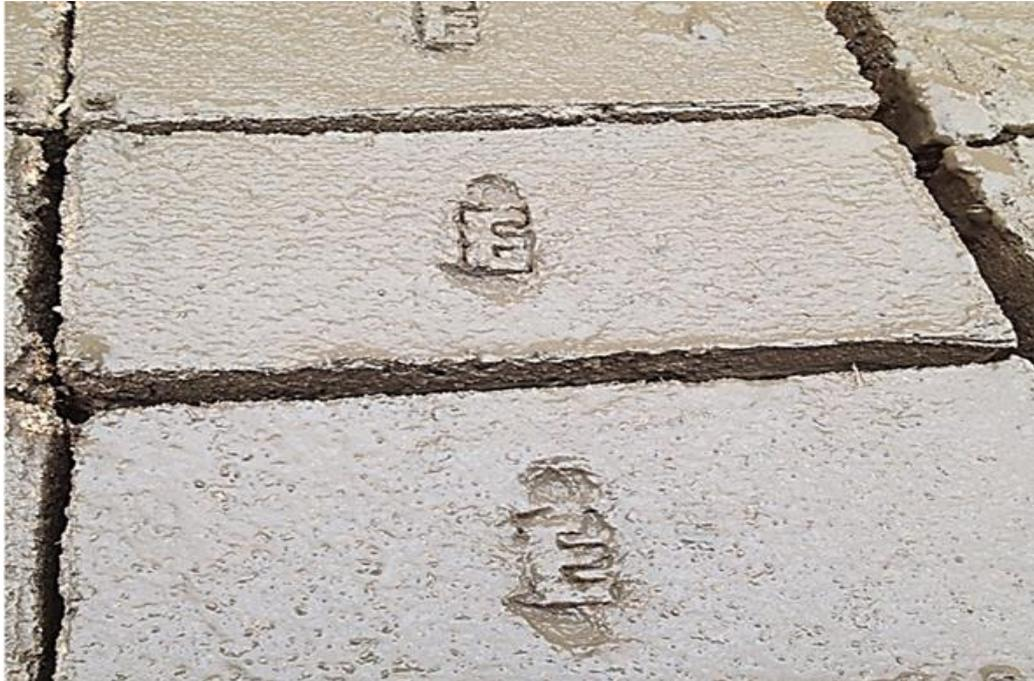
**Figura 3.15** Muestras “A” y “D”, con diferentes adiciones de lodos residuales, durante el proceso de secado.
