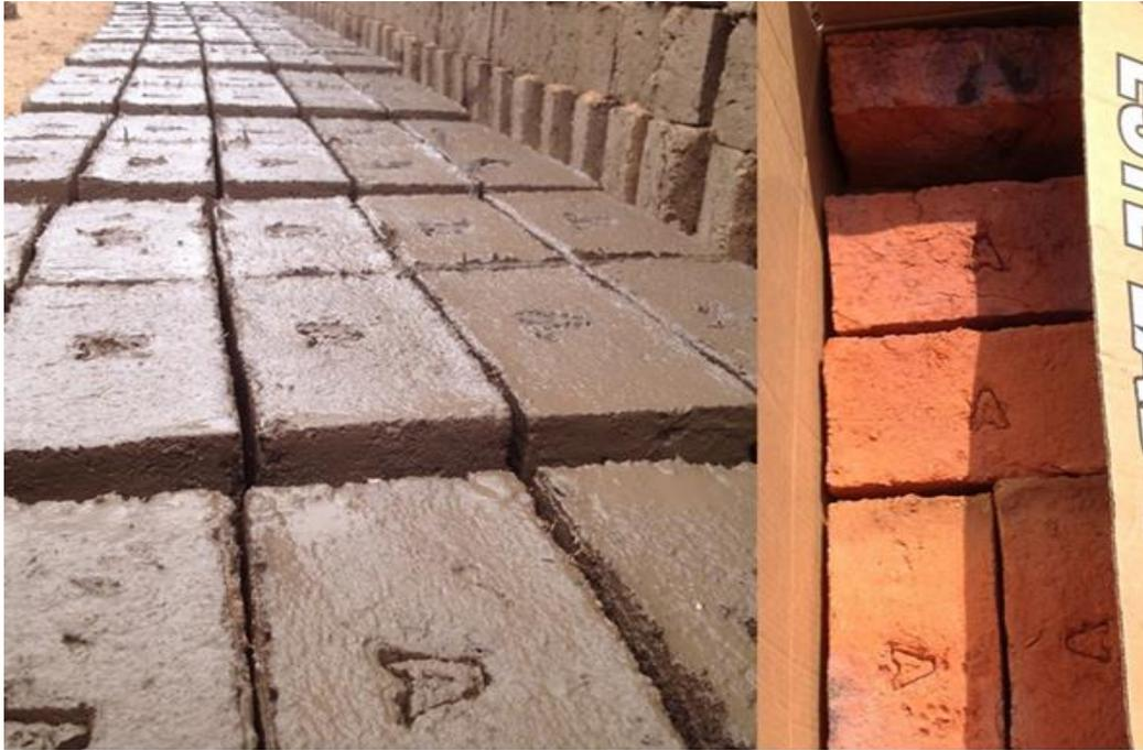
**Figura 3.13** Marcación de ladrillos muestra "E" con un contenido de 100% de lodos residuales.
