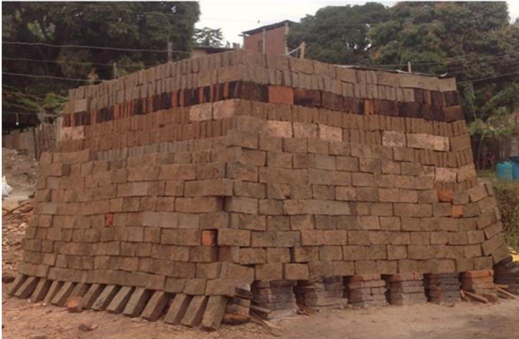
**Figura 3.20** Pirámide de cocción posterior al proceso de quema de ladrillos con muestras que contienen diversos porcentajes de lodos residuales adicionados.
