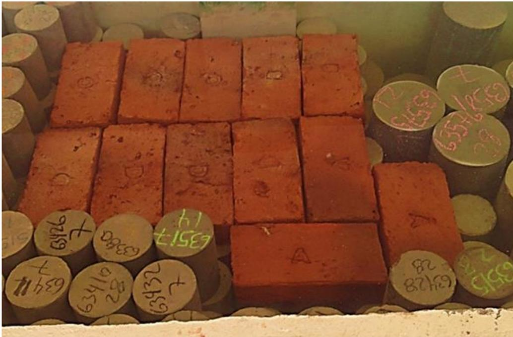
**Figura 3.23** Ladrillo con adiciones de lodos residuales, muestra "D".
