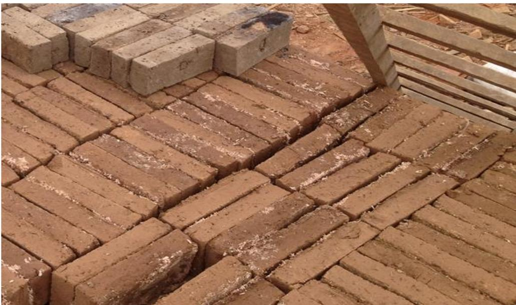
**Figura 3.19** Pirámide de cocción antes de la quema de ladrillos con diversos porcentajes de adición de lodos residuales.
