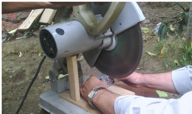
Figura 6.7Proceso de corte de especímenes semi-circulares.
