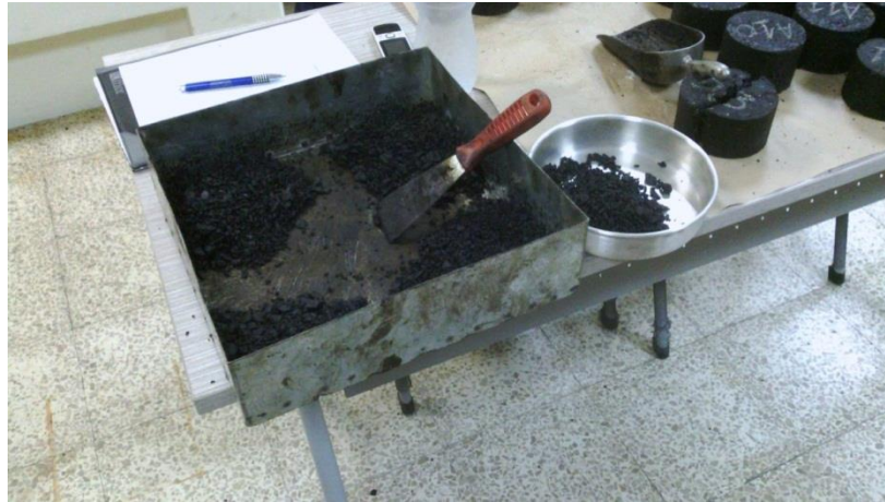
Figura 7.3 Cuarteo de mezcla para extracción de asfalto.
