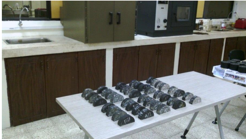
Figura 6.6 Briquetas para ensayo SCB con diferentes niveles de envejecimiento.
