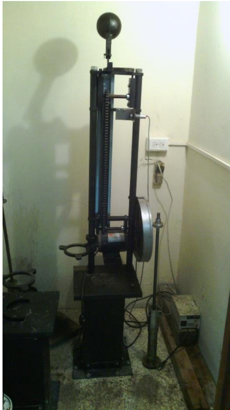
Figura 2.3 Martillo automático de compactación Marshall del laboratorio de pavimentos de la UCSG
