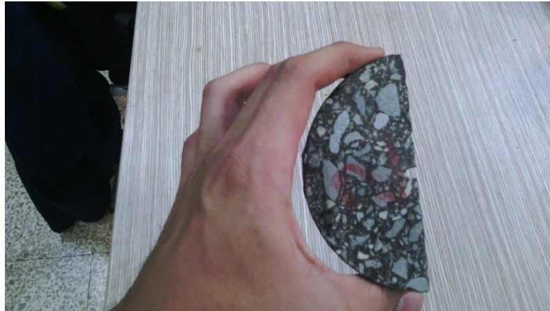
Figura 6.8 Espécimen semi-circular con ranura para ensayo SCB.
