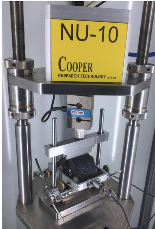
Figura 6.12 Ensayo de módulo de rigidez con equipo NAT
