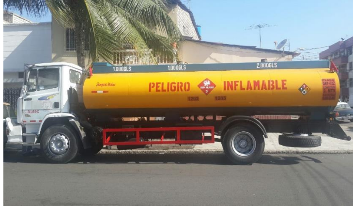
Ilustración 3 Auto tanque capacidad 4.000 glns.
