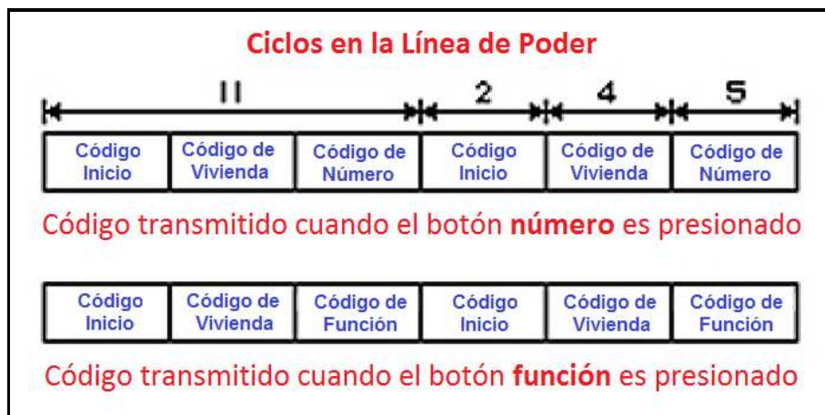
Figura 3.13: Ciclos de la línea de poder para la transmisión de código X-10 Fuente: (Rye, 2015)
