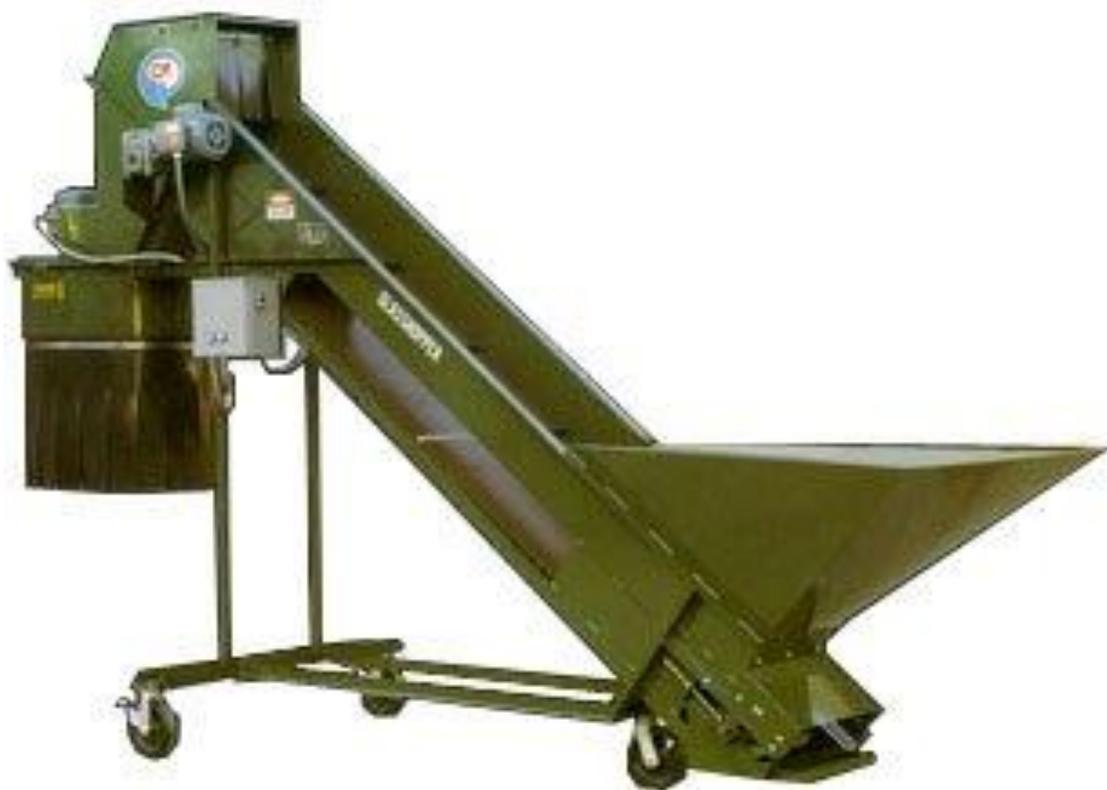
Figura 14 *Máquina trituradora de vidrio*
