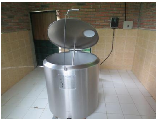
Figura 43. Tanque de Enfriamiento De Laval Bolsio Elaboración: Karen Albuja
