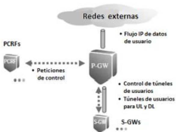
Figura 2.6: Elementos de P-GW (Puerta de Red de Paquetes de Datos) Fuente: (Guevara & Vasquez, 2013)
