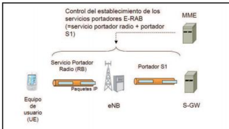
Figura 2.10: Control de los servicios portadores radio y S1 a través de la interfaz S1-MME Fuente: (Meza & Santin, 2014)
