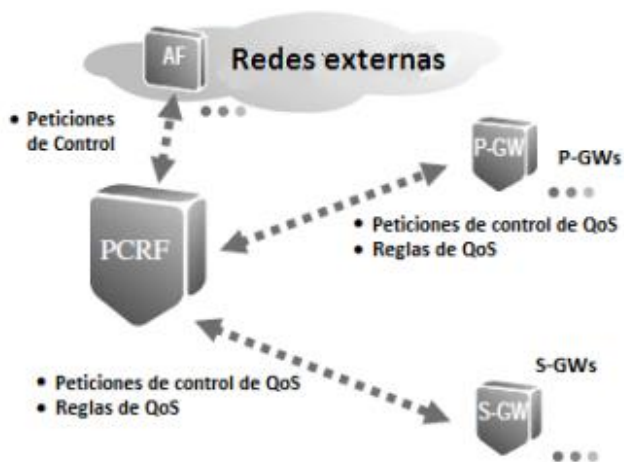
Figura 2.7: Elementos de PCRF (Función de Políticas y Reglas) Fuente: (Guevara & Vasquez, 2013)
