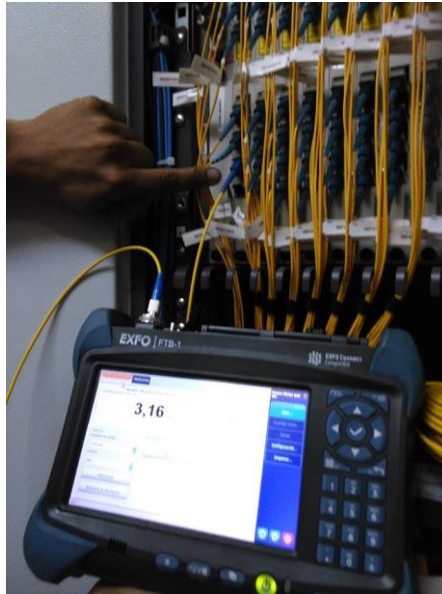
Figura 29 El OTDR marca la potencia que emite la OLT
