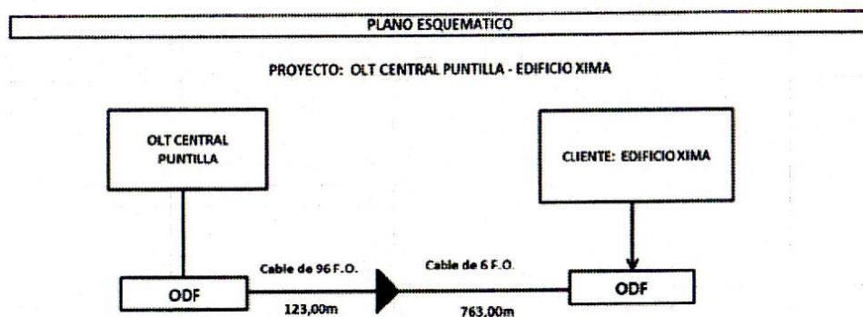
Figura 13.1 Plano esquemático de la distribución del backbone MPLS FTTH
