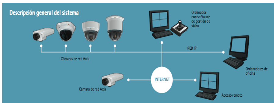
Figura 19 Sistema de cámaras de vigilancia IP
