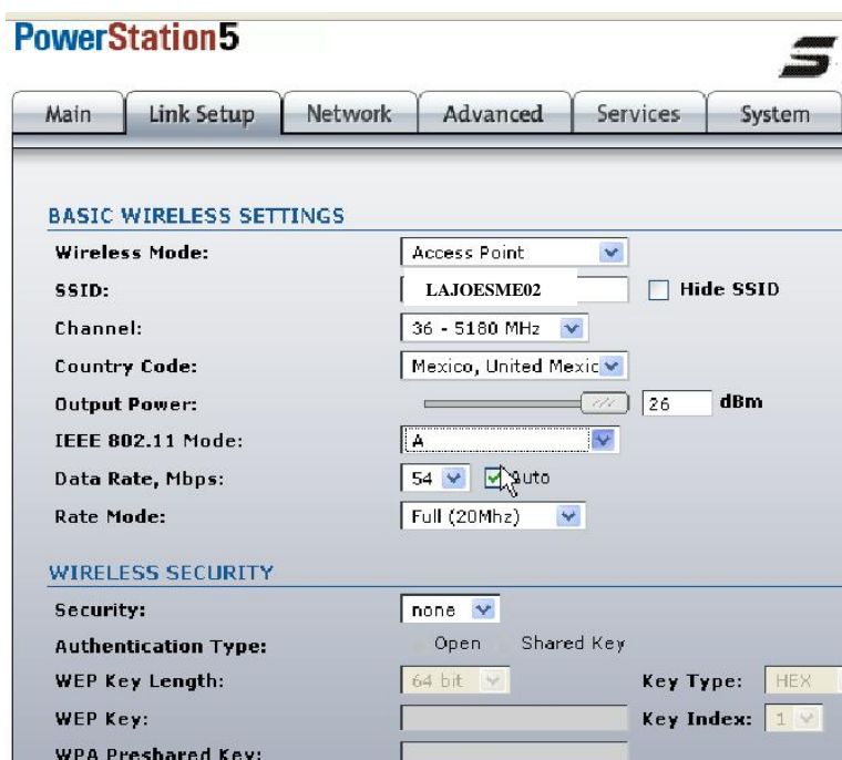
Figura 40 Interfaz de configuración de la antena Sectorial AM-5G17-90
