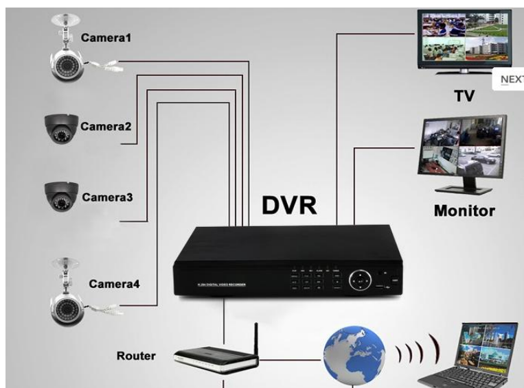
Figura 17 Utilización de DVR en sistemas de cama analógicos
