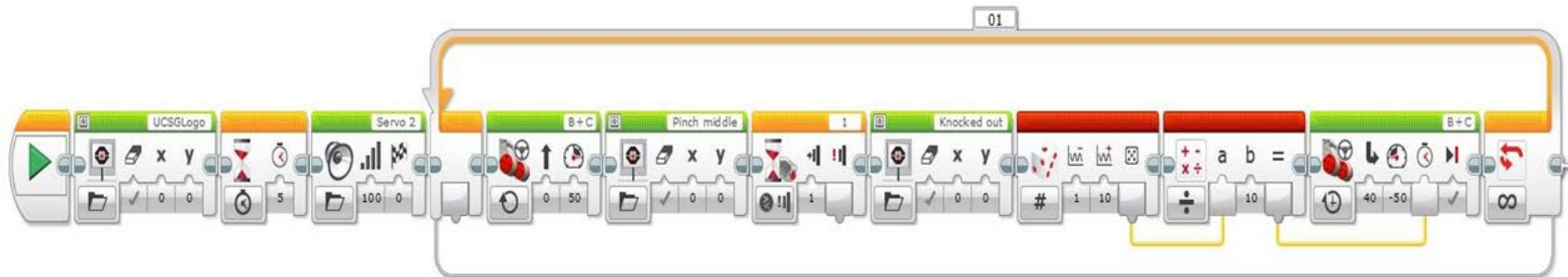
Figura 3. 25: Programación para la detección de colisiones por medio del sensor Touch conectado en el puerto 1 del bloque EV3. Elaborado por: Autores.
