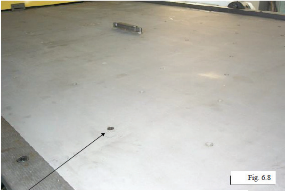
Tornillo usado para asegurar el troquel a la mesa para troquel
