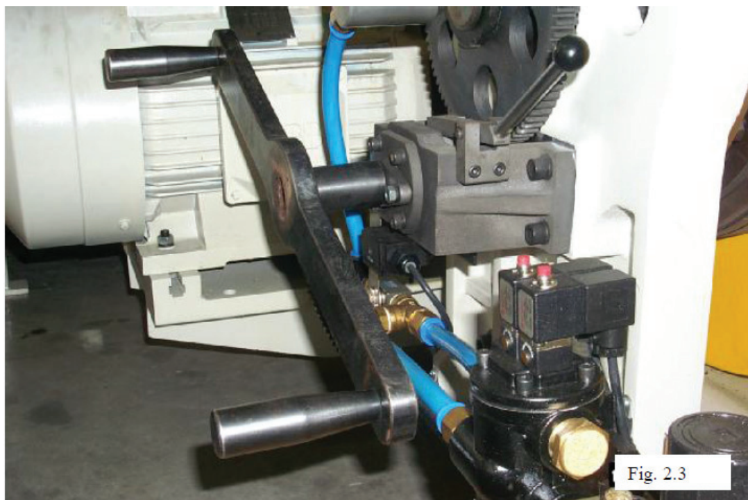
Trinquete reducido y sistema de seguridad para el mecanismo de accionamiento manual
