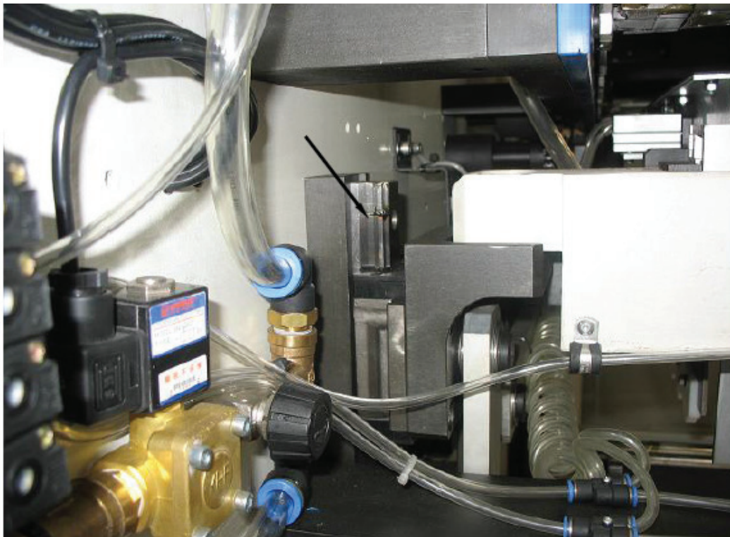
Figura 14. Parte inferior de la Vía de Guía lineal del asiento para desperdicios. (Simétrico) Tipo de llenado de aceite: Tipo B
