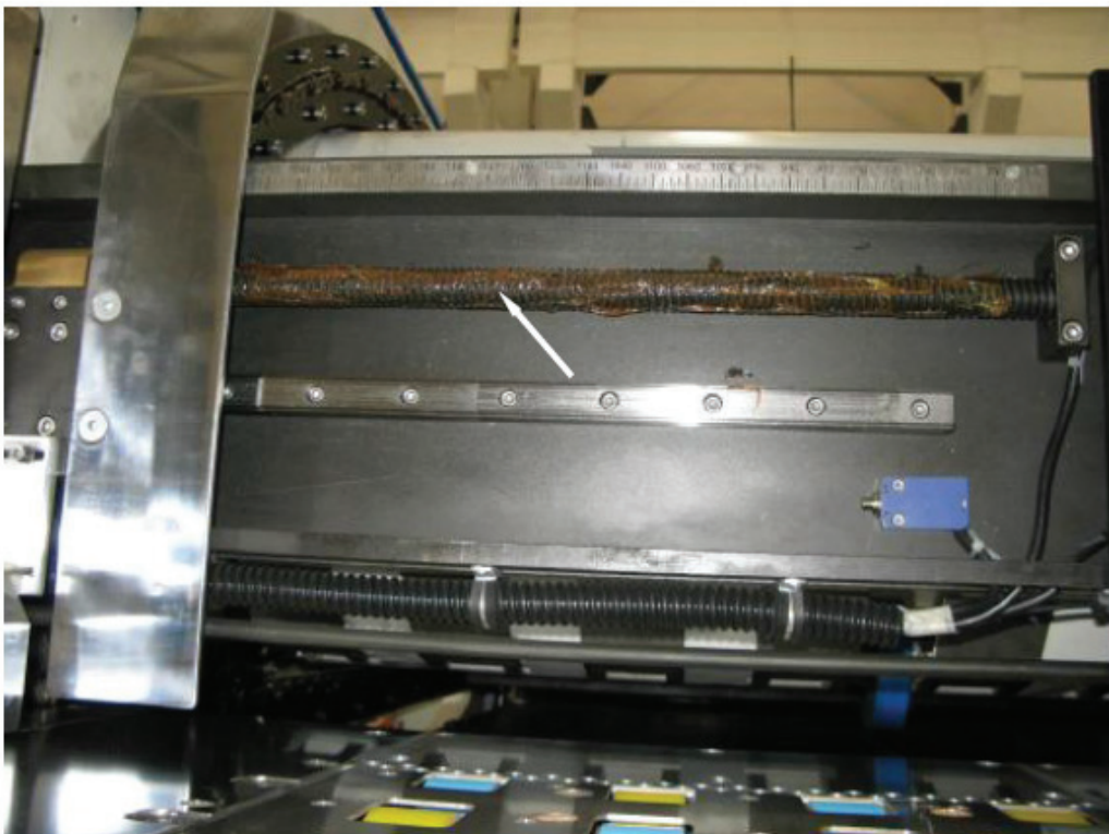
Figura 4. Guía de Vara de tornillos laterales (simétrico). Tipo de llenado de aceite: Tipo A
