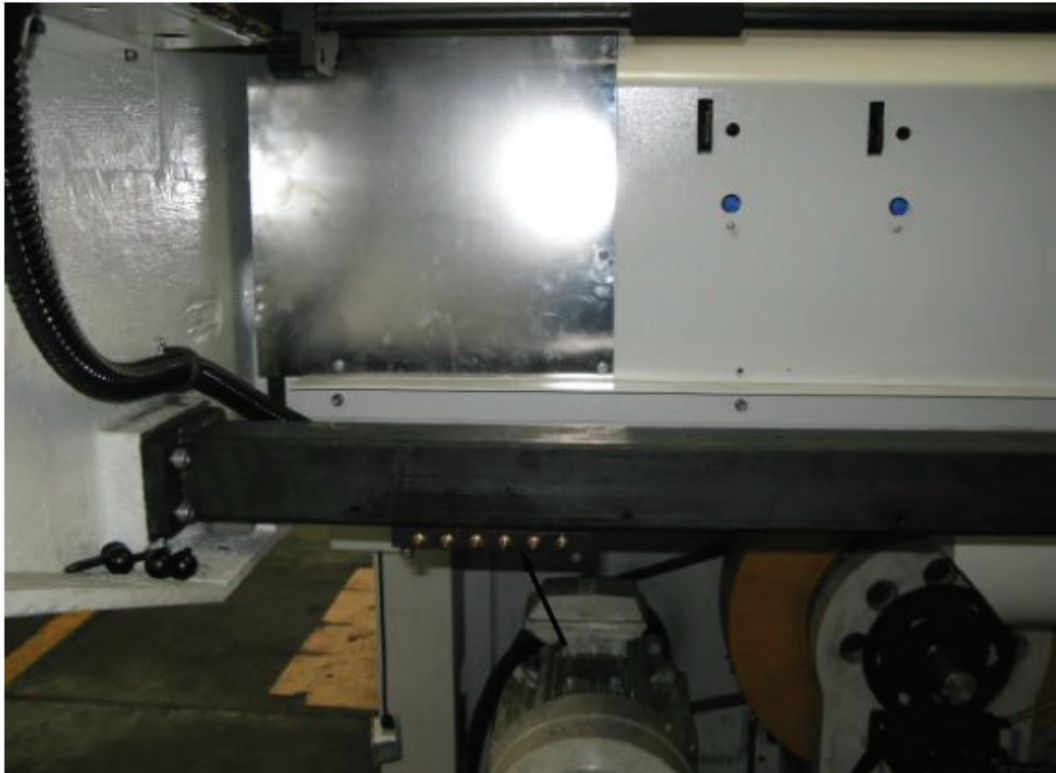
Figura 1. Boquilla de crema del mecanismo frontal de lubricación de la cinta transportadora. (Simétrico, llenado tipo A)
