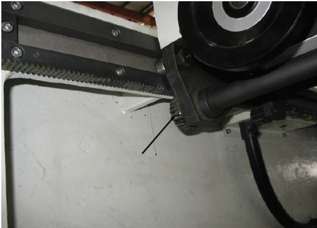
Figura 2. Repisa de apoyo móvil (simétrico), tipo de llenado de aceite: Tipo A
