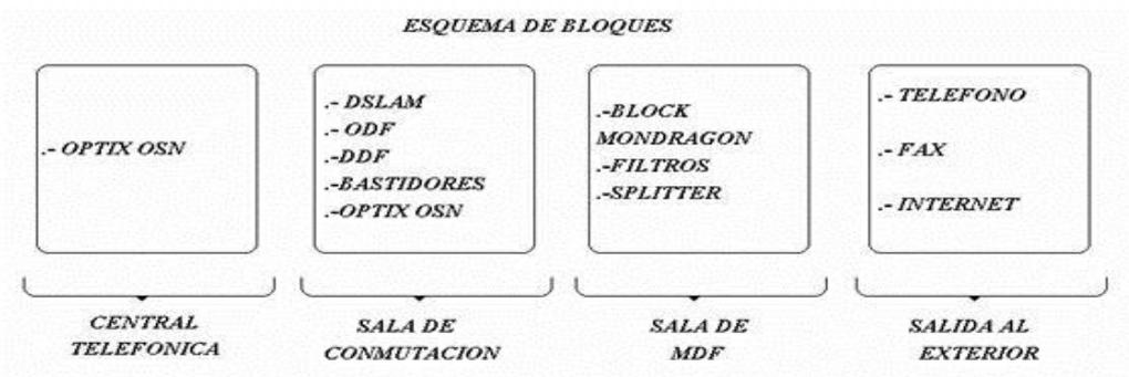
Figura 3.39: Diagrama de bloques de una red de comunicaciones en banda ancha
