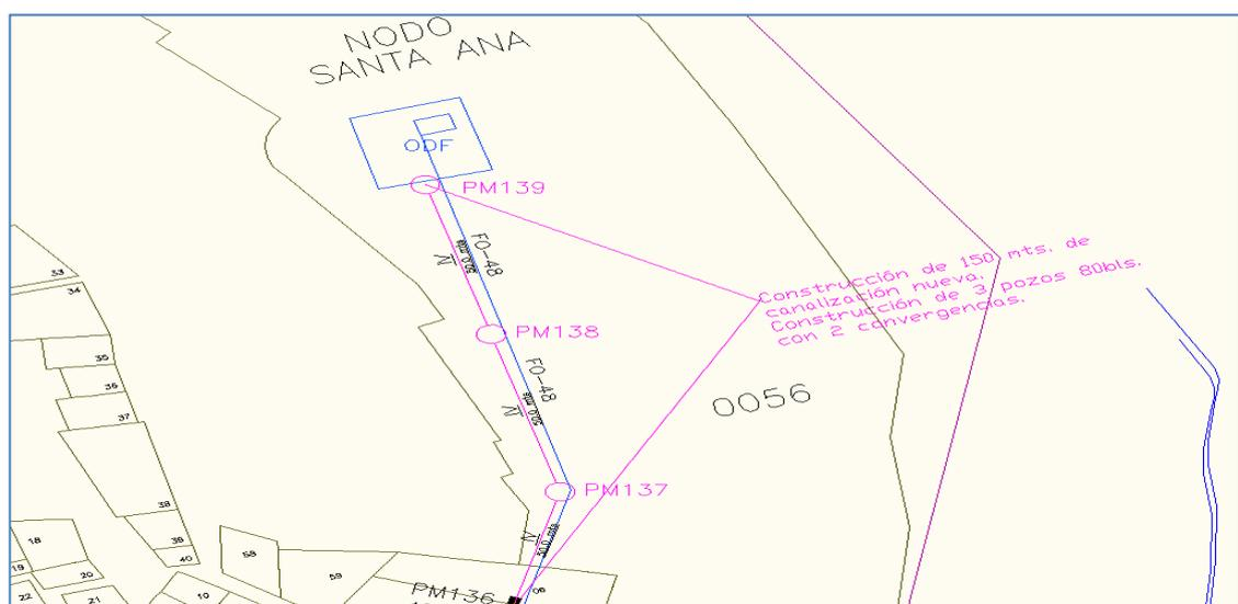
Figura 4.3: Ruta del eje de canalización a construirse para el proyecto Puerto Santa Ana
