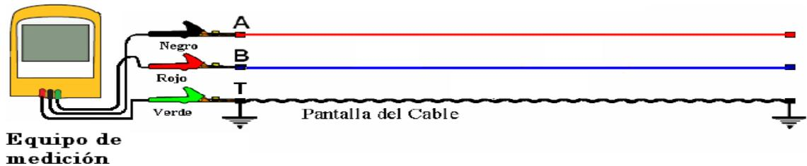
Figura 3.35: Prueba de ruido a tierra
