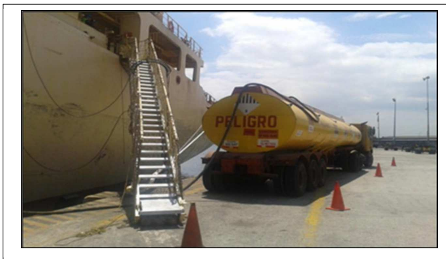
Figura 3 Vehículo tanquero realizando extracción de aguas oleosas.
