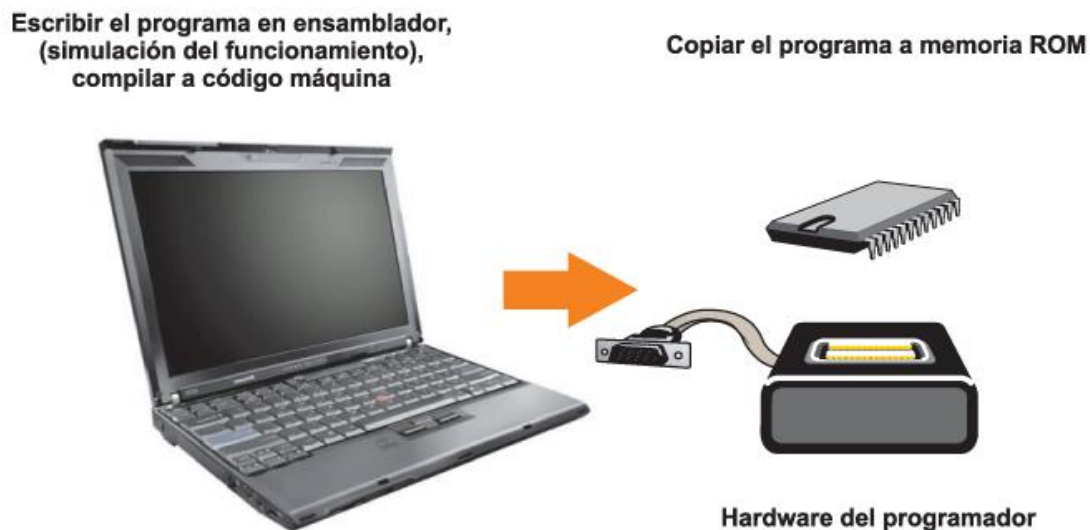
Figura 2. 7: Proceso de grabar el programa a una memoria ROM. Fuente: Mikroelektronika
