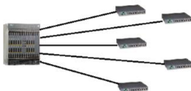
Figura 2.7 Conexión directa de la OLT con los ONT
