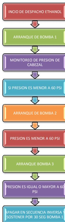
**Figura 0.5 Diagrama de Bloques para nueva lógica de arranque de bombas de ethanol**
