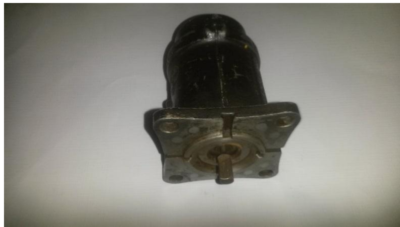
FIGURA 43: Generador tacómetro de motor vista posterior
