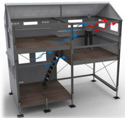
Figura 46: Uber Shelter Ingreso de ventilación
