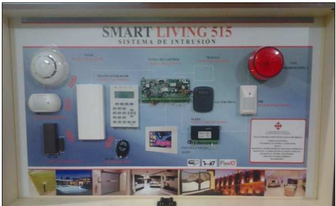
Figura 4.6 Sistemas de Intrusión SmartLiving
