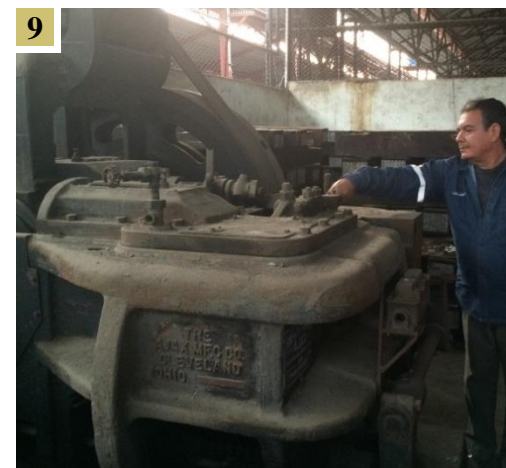
Figura 69. Máquina para elaborar pernos Autor: Ramón (2014)
