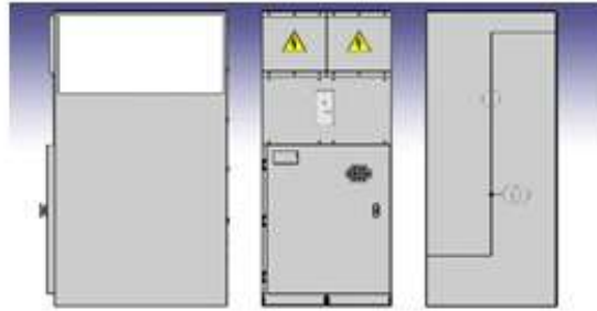
Figura 7 Celdas de media tensión de protección general. Fuente: Ingeniería Triple E. (Ingeniería Triple E)
