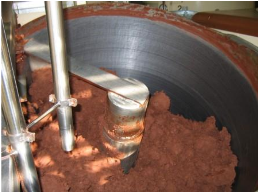
Figura 2. 21. El proceso de conchado
