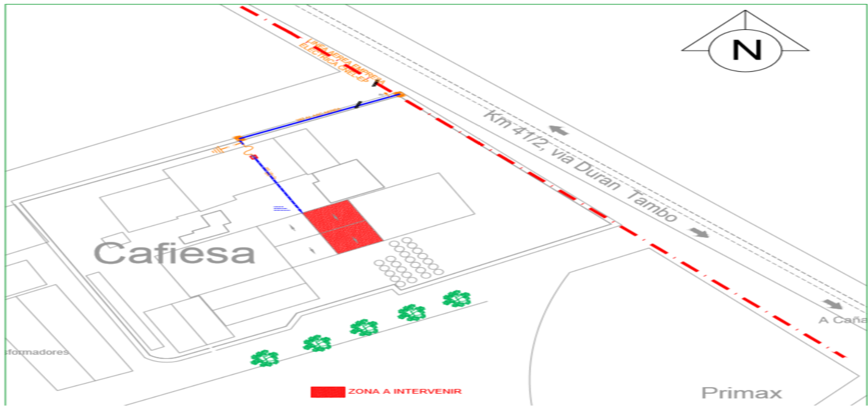
Figura 3. 5. Acometida eléctrica en media tensión
