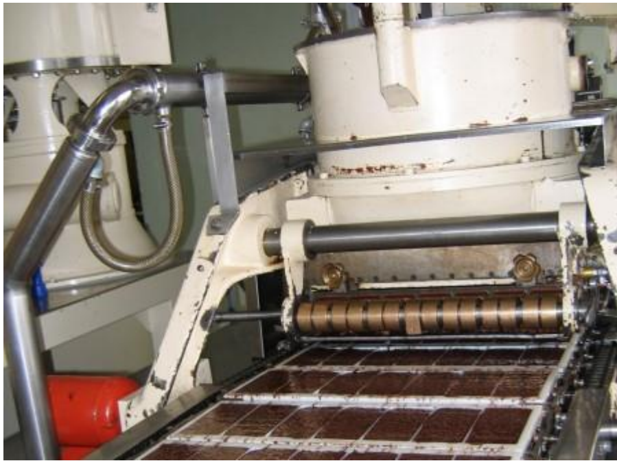
Figura 2. 22. El proceso de templado del chocolate
