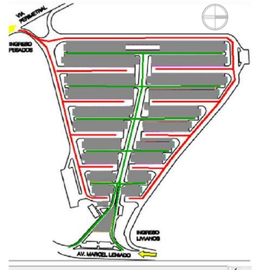
Figura 42. Esquema de circulación vehicular
