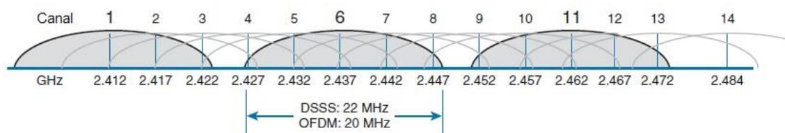
Figura 2.17: *Canal distribuido en la banda de 2.4 GHz.* Hucaby, D. (2014). Recuperado de ( Guía Oficial de Certificación CCNA Wireless 640-722)
