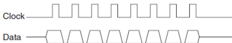
Figura 2. 12: Sincronismo serial de datos utiliza un reloj para indicar cuando los bits de datos son válidos. Fuente: Pérez, E. M. (2007),
