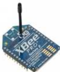
Figura 3. 4: Dispositivo electrónico – Antena XBee Pro. Fuente: El Autor.
