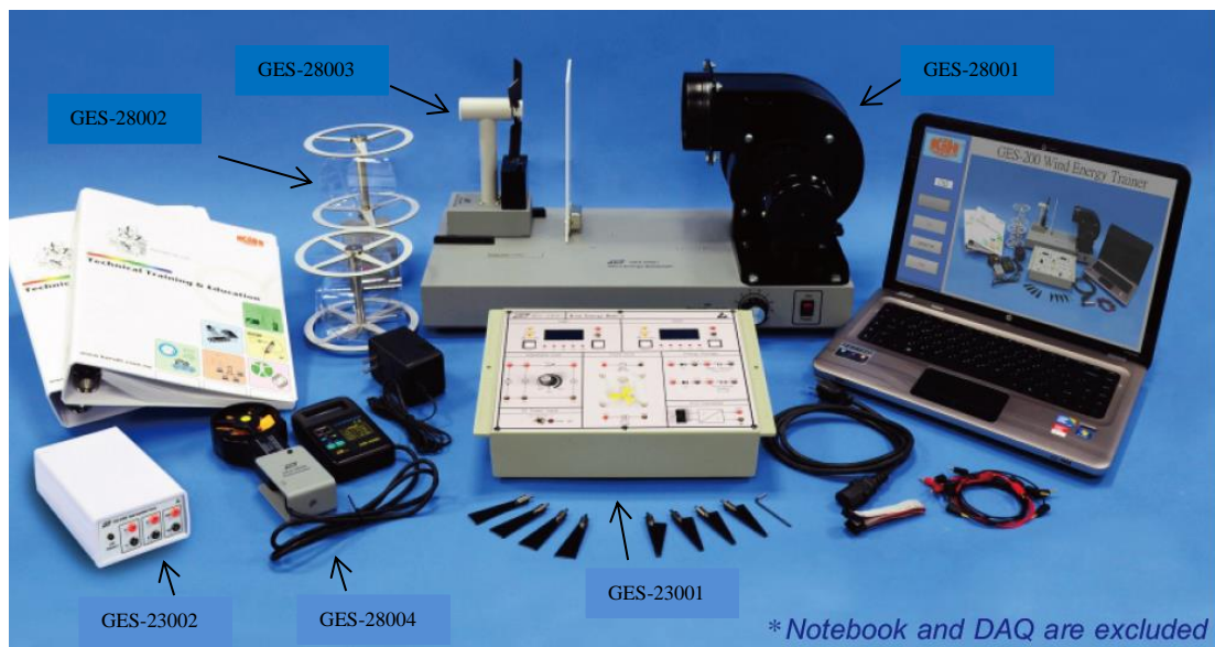
Figura.6.2 Entrenador de eólico GES-200
