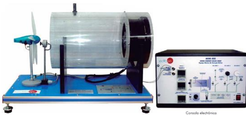
Figura 6.4 Módulo de energía eólica Fuente: Edibon (2013).
