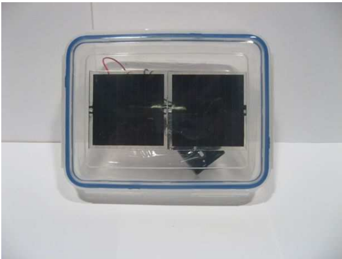
Figura 3.23: Cargador solar terminado
