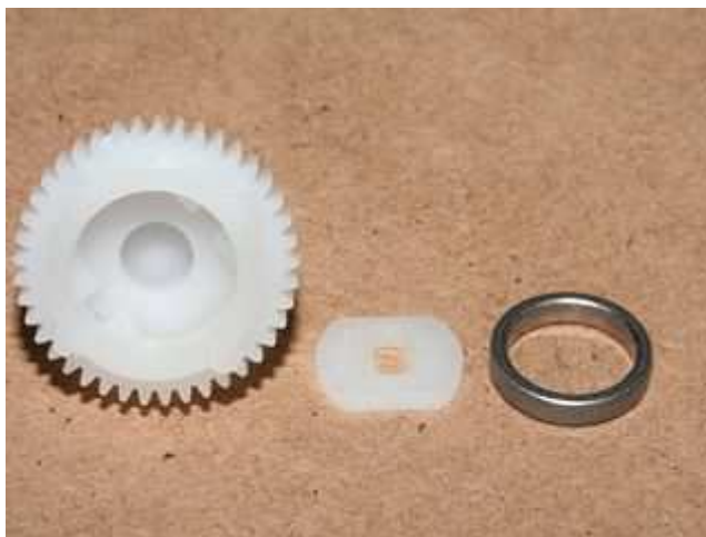
Figura 3.6: Engrane principal con placa plastica
