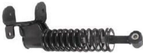
Figura 2.11 amortiguador contra golpes frontal derecho.
