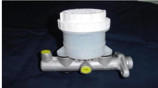
Figura 2.18. Bomba de freno con depósito para el líquido de frenos Fuente: (catalogo diario el universo)
