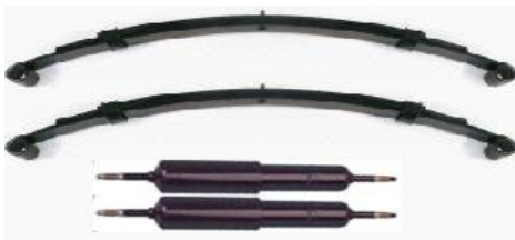
Figura 2.9 ballesta y amortiguadores
