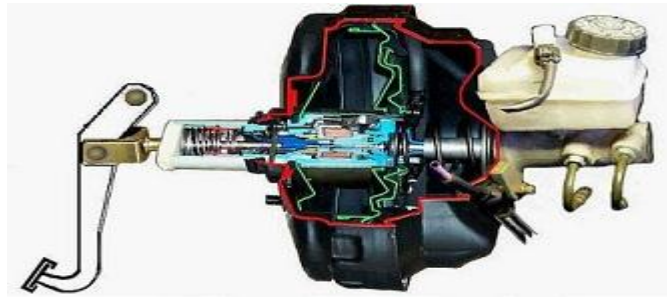
Figura 2.17. Montaje de servofreno y bomba de freno. Fuente: (catalogo diario el universo)
