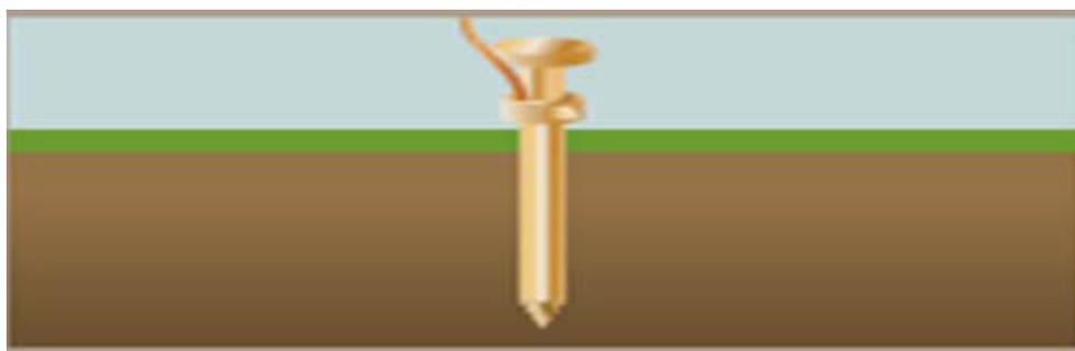
**Figura 1** Electrodo único de conexión a tierra.
