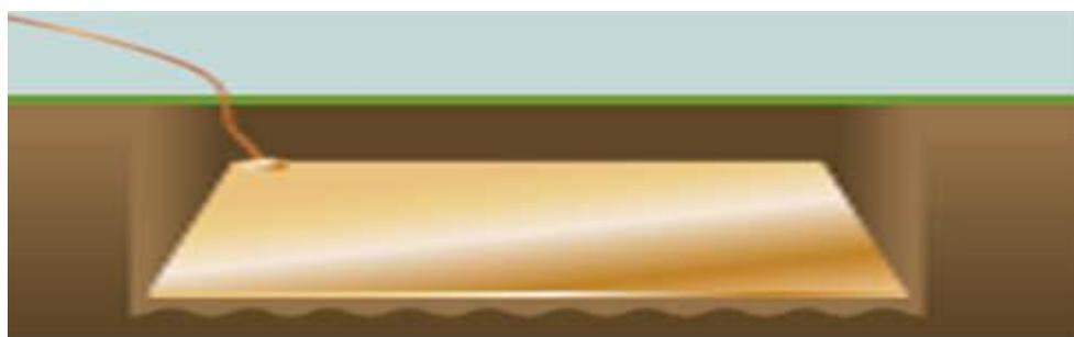
**Figura 4** *Placa de conexión a tierra.*
