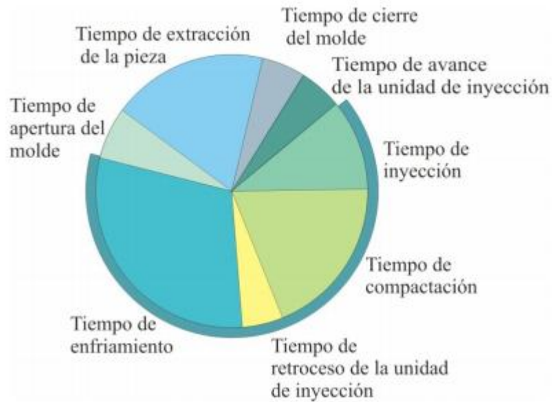
Fig. 2.7 Tiempo de ciclo de inyección en una maquina convencional Fuente: http://iq.ua.es/TPO/Tema5.pdf pag 15
