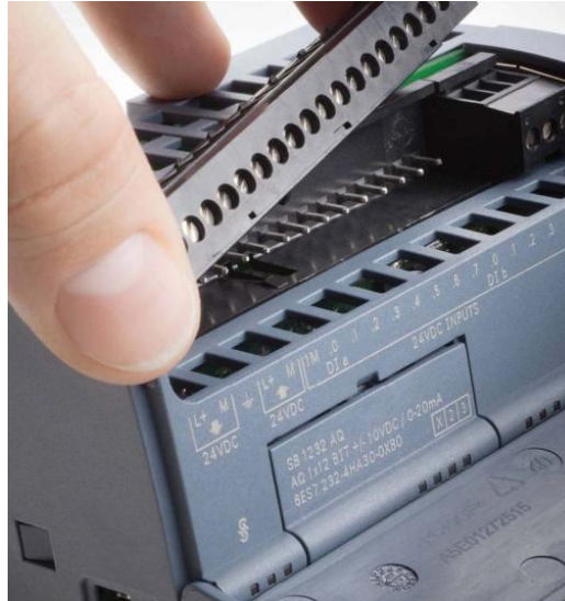
Fig. 4.3 Características de S7 – 1200 (desmontaje de terminales)
