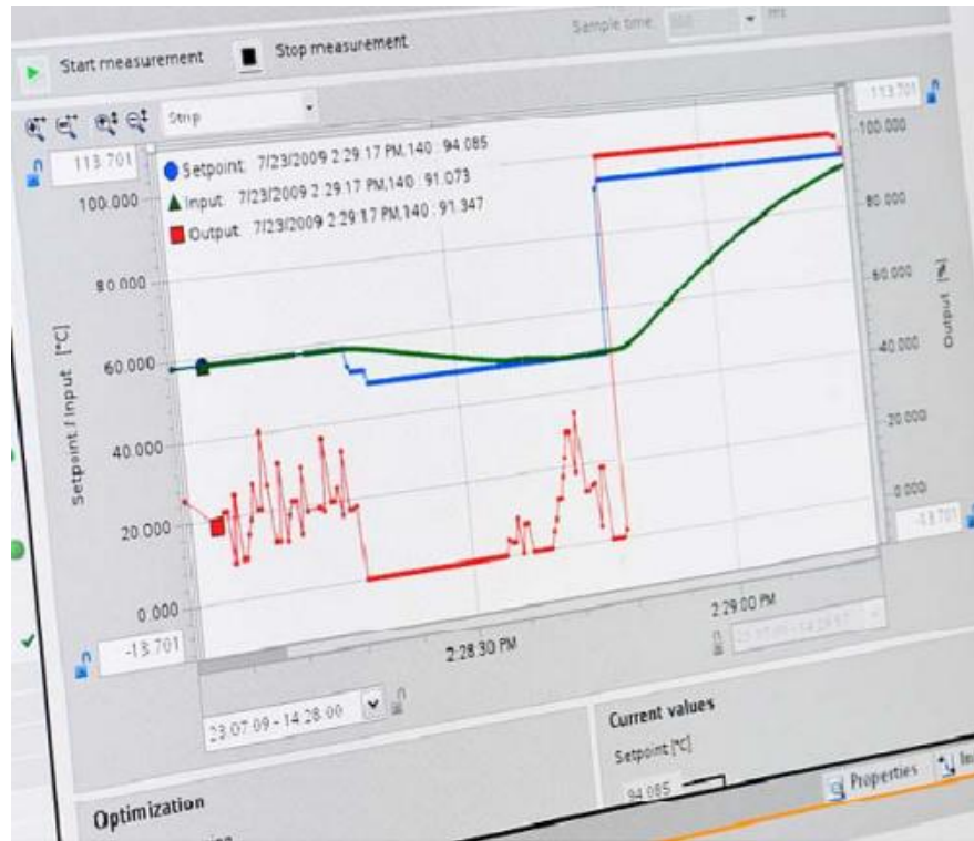
Fig. 4.6 Herramienta de PID para la visualización on line del control S7-1200 Fuente: https://www.swe.siemens.com/spain/web/es/industry/automatizacion/sce_educacion/documentacion/Documents/SIMATIC%20S71200R.pdf pag 70
