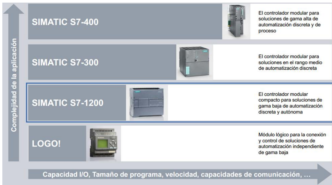
Fig. 4.2 Clasificación de la gama de PLC SIEMENS
