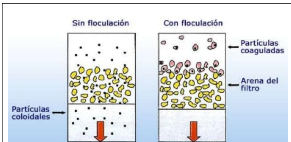
Figura 6. Esquema del principio de coagulación o floculación
