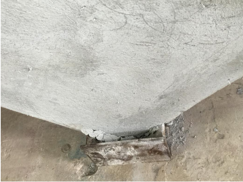
Imagen 14. Resultado de prueba (la pared falló)
