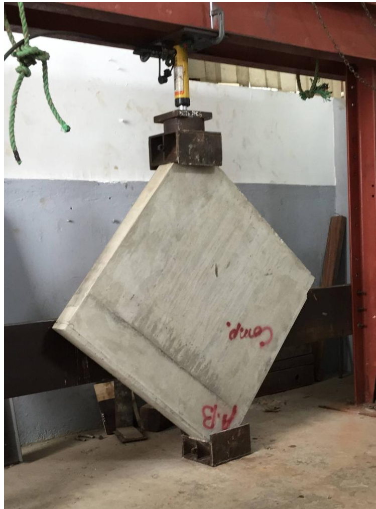
Imagen 18. Pared compuesta por bloques de acero reforzada con fibras de acero (2013)
