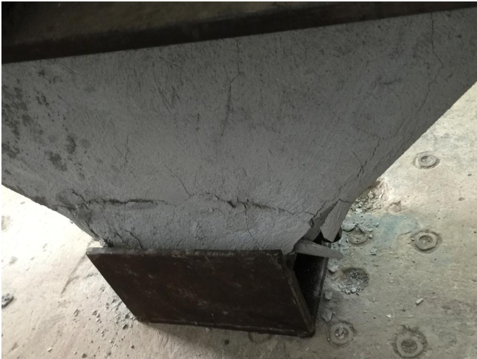
Imagen 14. Resultado de prueba (la pared falló)
