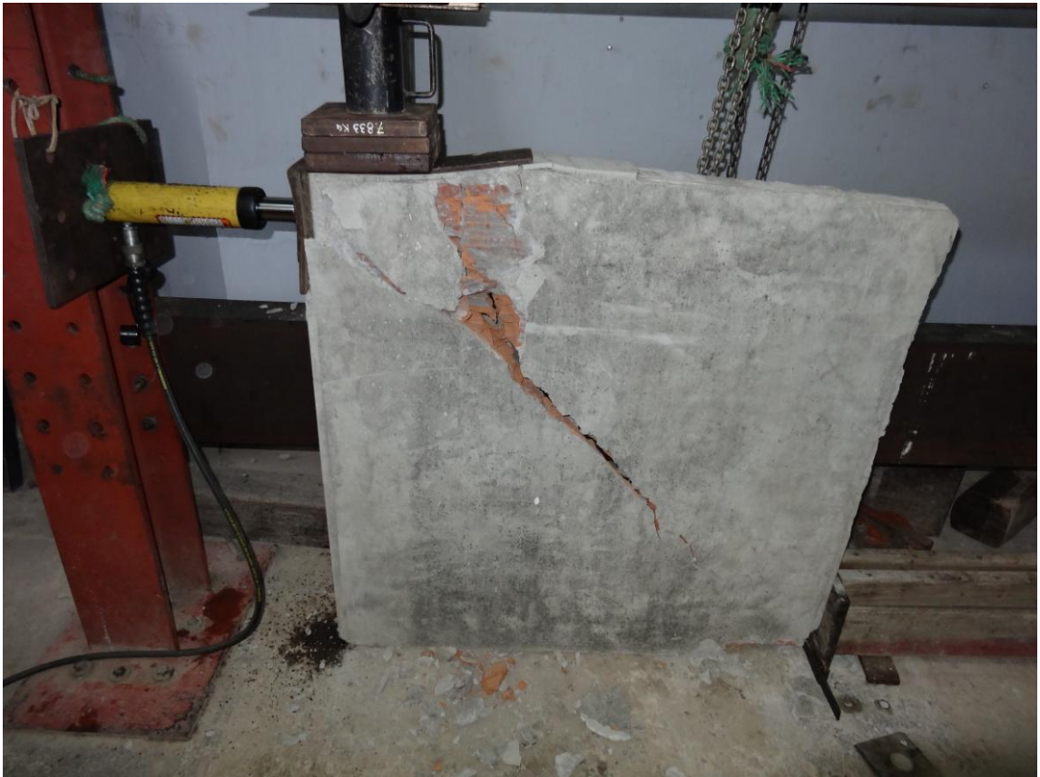
Imagen 6. Resultado de prueba - Pared con Fibra de Acero (2013)
