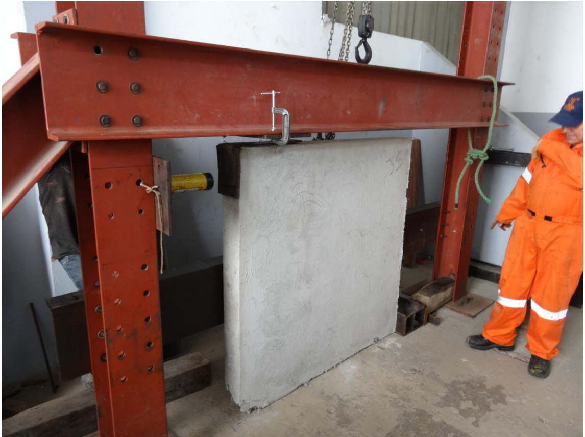
Imagen 3. Pared ajustada al pórtico
