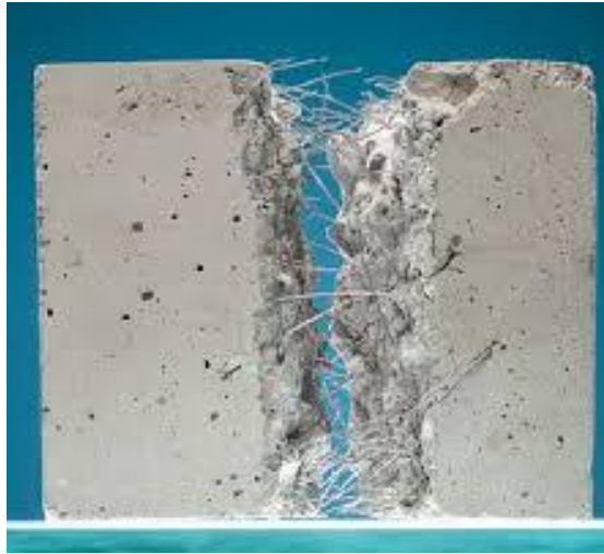
Figura 8. Bloque de hormigón y fibra de acero
