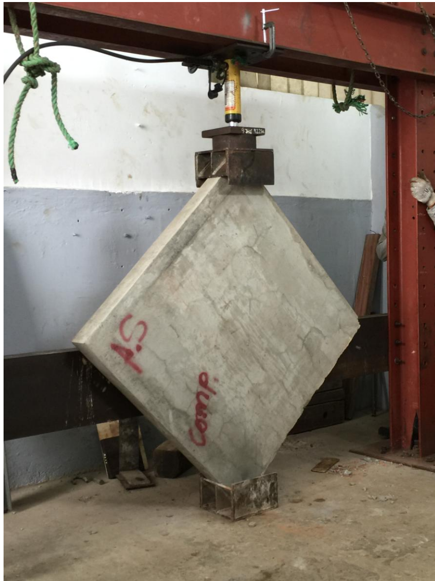
Imagen 16. Pared compuesta por bloques de arcilla reforzadas con fibras de acero (2013)
