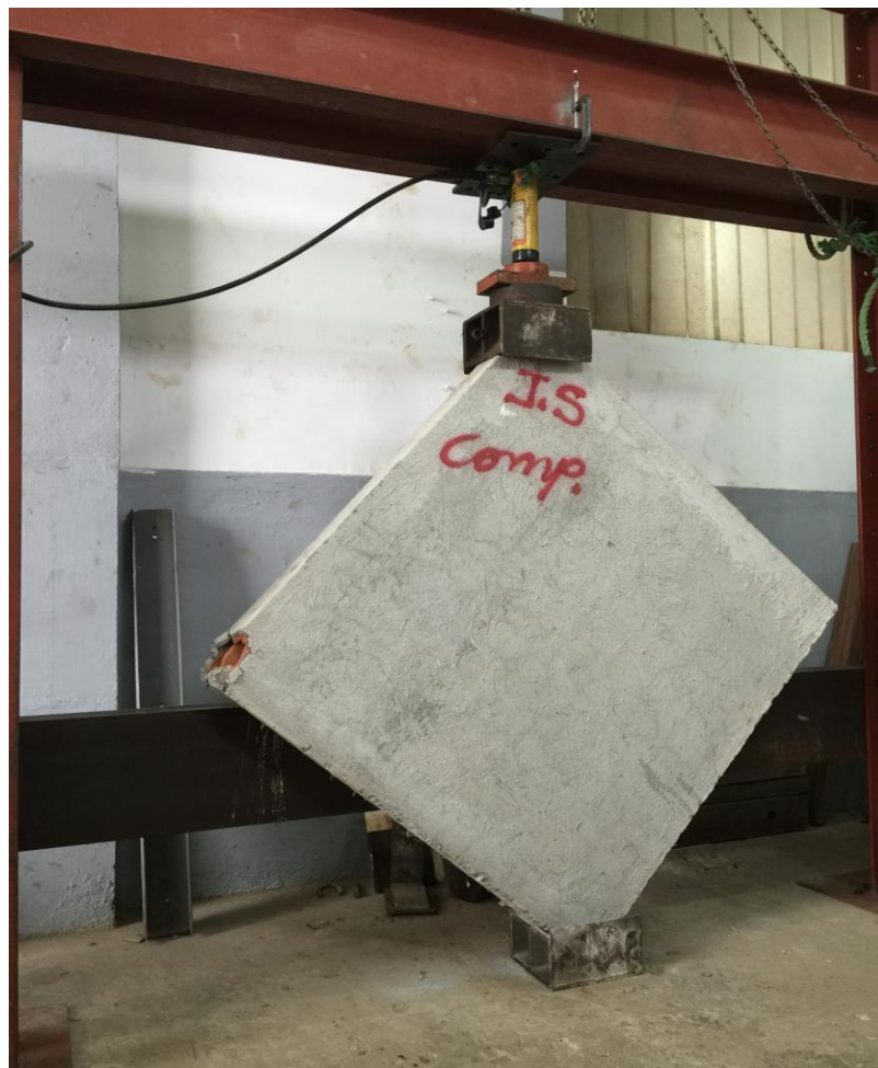
Imagen 10. Pared de bloques de arcilla reforzada con fibras artificiales de polipropileno (2012)
