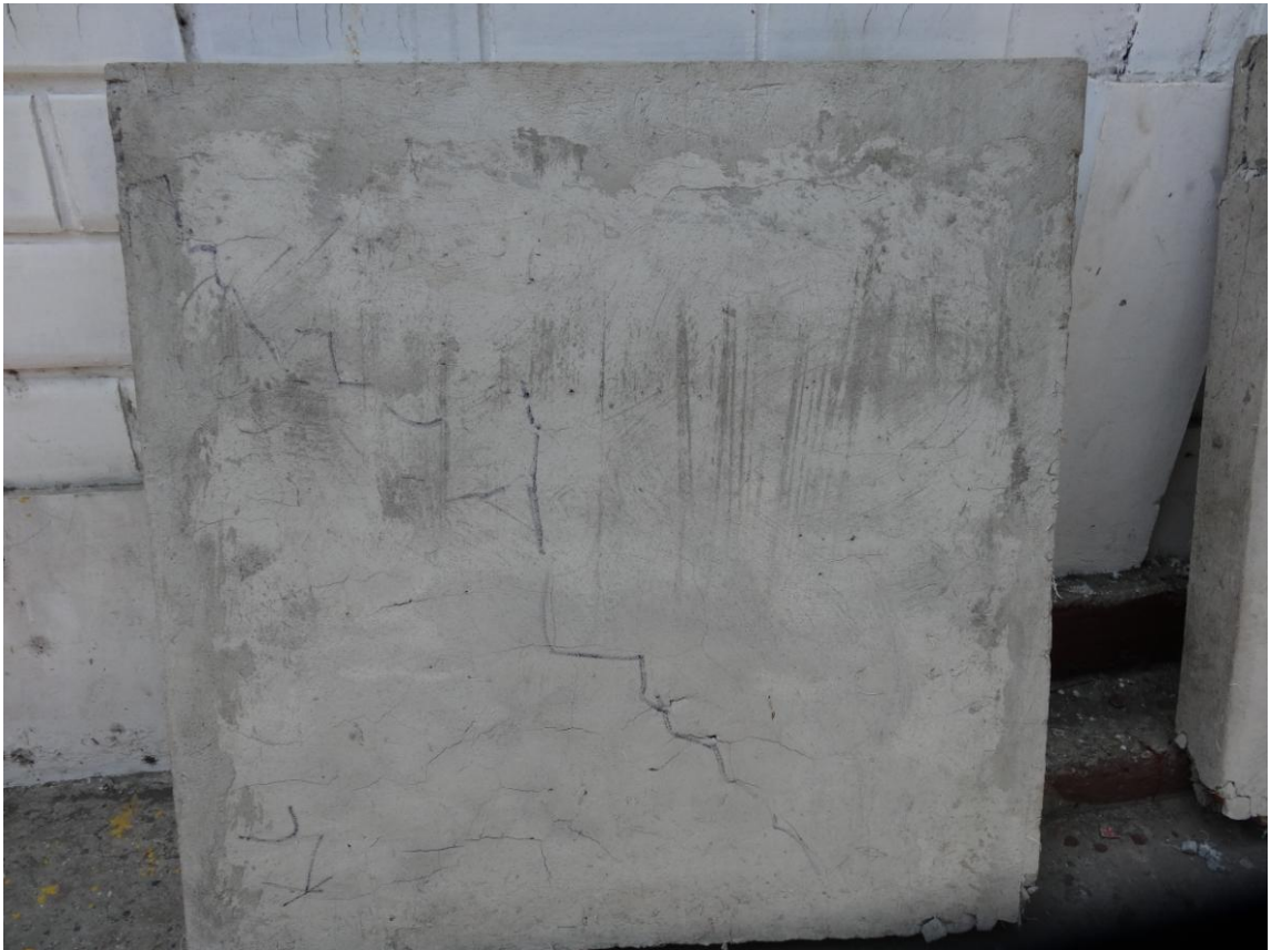
Imagen 5. Resultado de prueba - Pared con Fibra Vegetal (2012)
