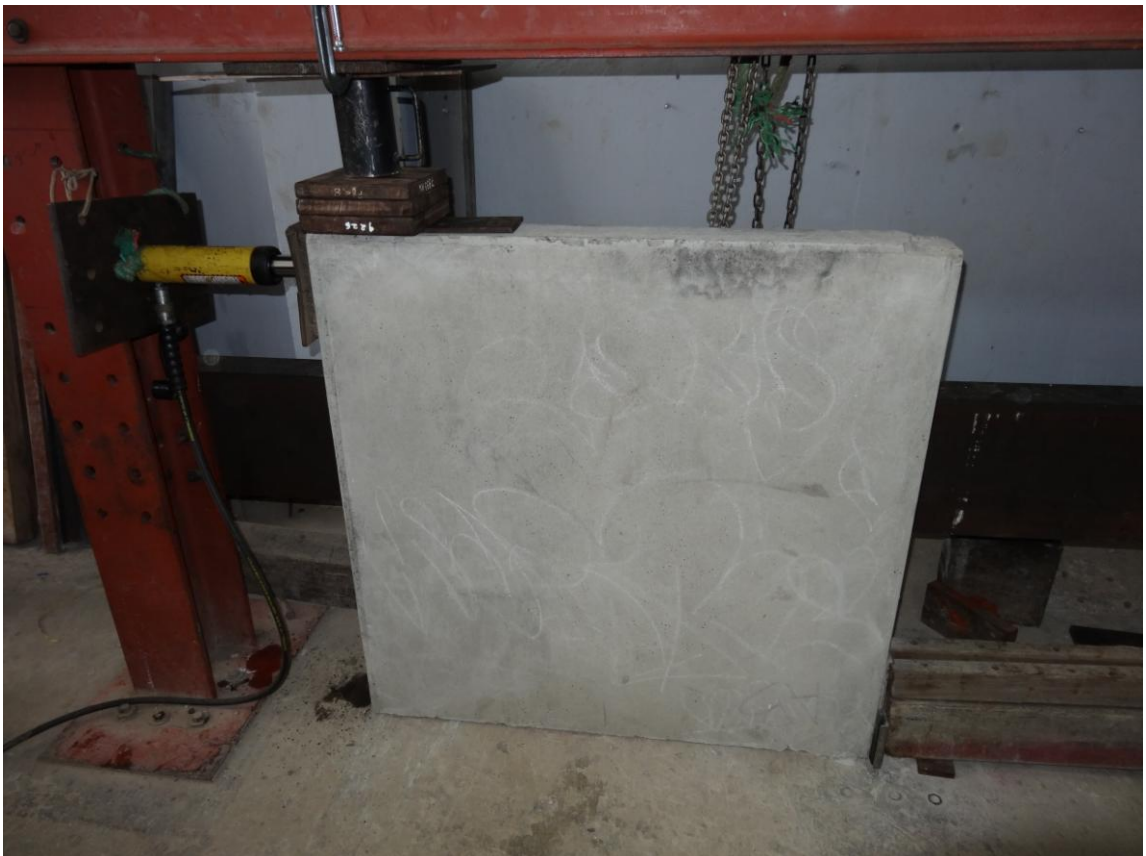
Imagen 7. Resultado de prueba - Pared con Bloques de concreto y fibras de acero (2013)
