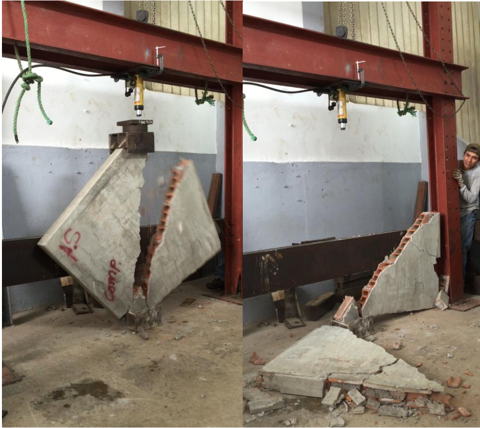
Imagen 17. Resultado de prueba (pared se parte en dos)
