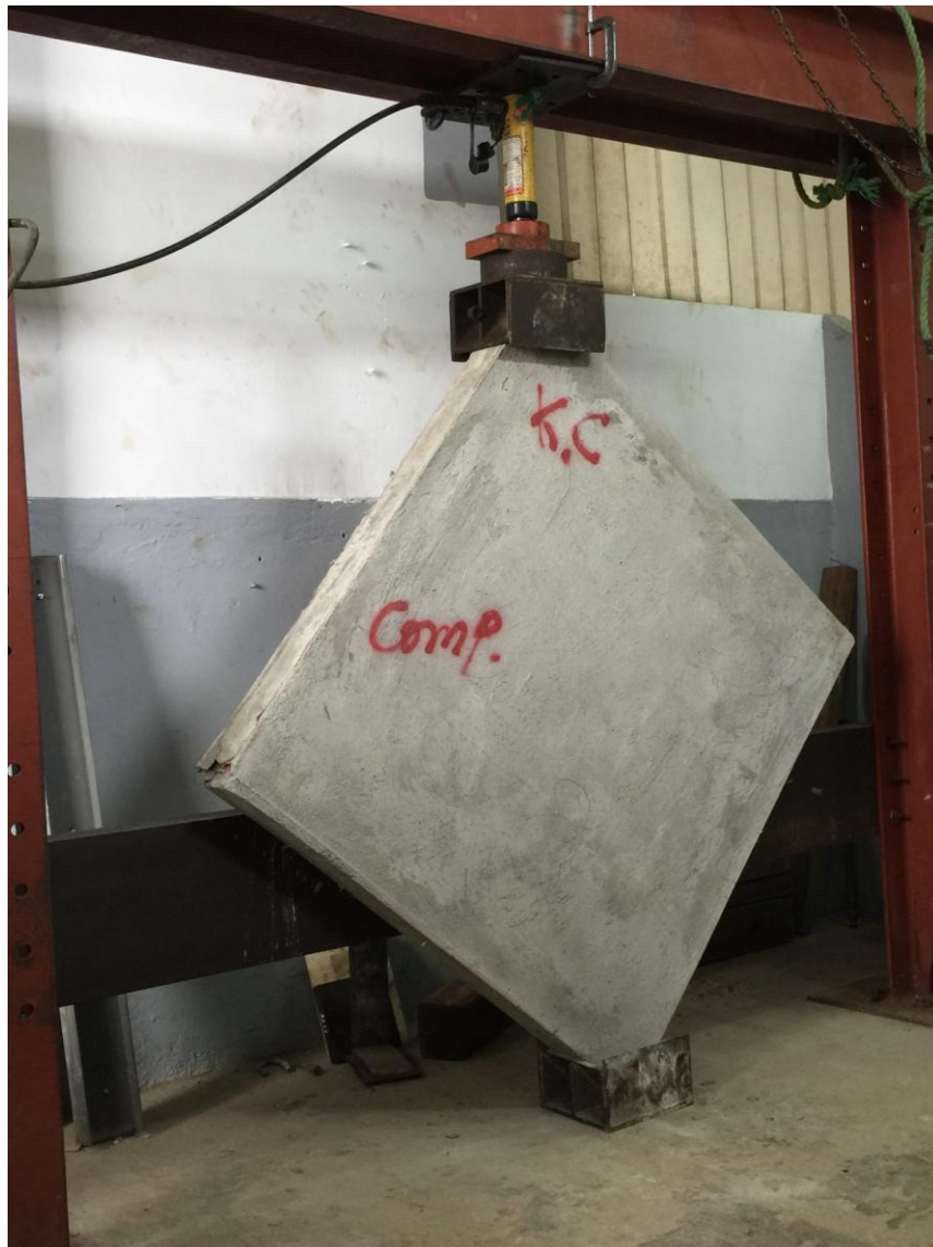
Imagen 13. Pared compuesta por bloques de arcilla reforzado con fibras vegetales abacá (2012)
