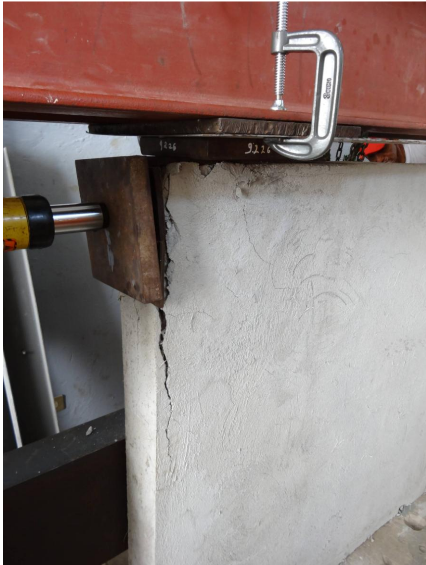
Imagen 4. Resultado de prueba - Pared con Fibra artificial (2012)
