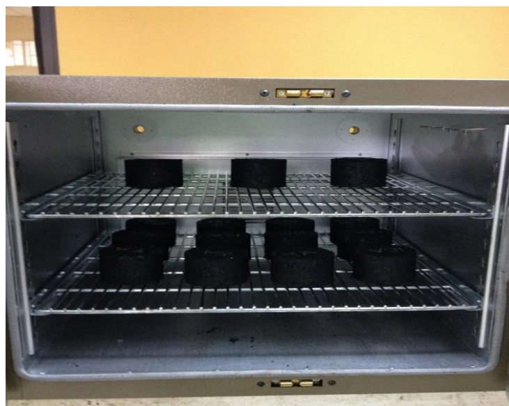
Grafico 6-4 Colocación de las briquetas en el horno (Fuente: autor)
