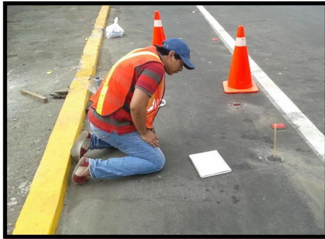
**Figura 11: Medición de las temperaturas de la capa asfáltica a diferente profundidades in situ**
