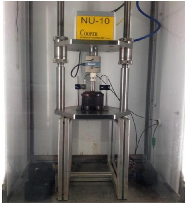
***Figura 4: Ensayo Crep Estático en el equipo NAT.***
