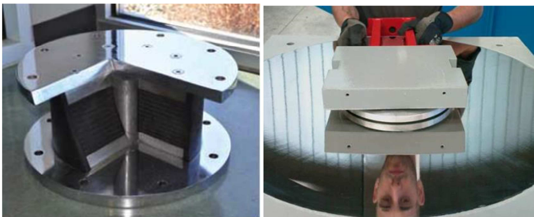
Figura 3.6: Aisladores de base; Izquierda: aislador elastomérico con núcleo de plomo (Sánchez, 2014); Derecha: aislador friccional deslizante ( http://www.redpavia.com/projects/project4/2.jpg ).
