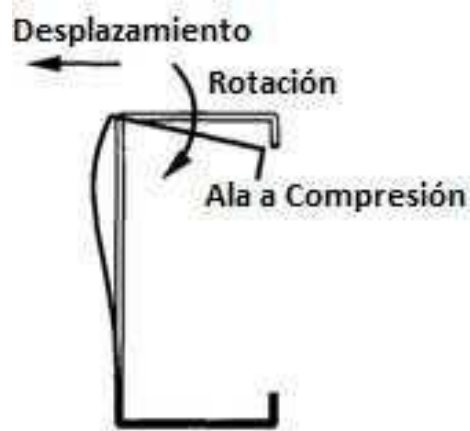
Figura 35. Pandeo Distorsional en Elementos a Flexión
