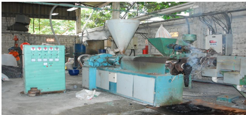
Anexo 10 Maquina Desgacificadora
