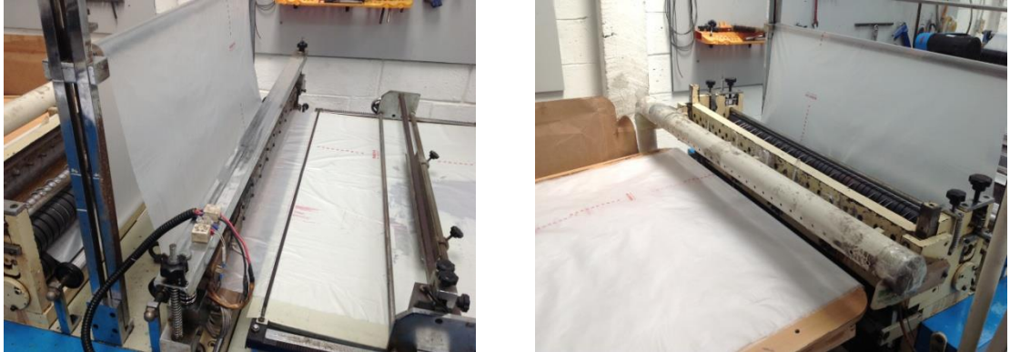
Gráfico 38 - Maquinas selladoras produciendo protectores.
