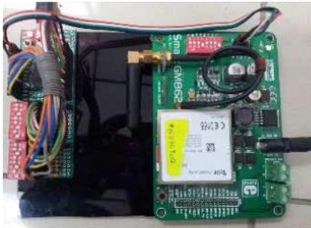
*Figura 4.14 PIC 18F2550 y módem GSM*
