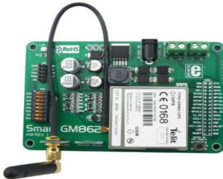
*Figura 3.6 Módem GSM/GPRS telit.*
