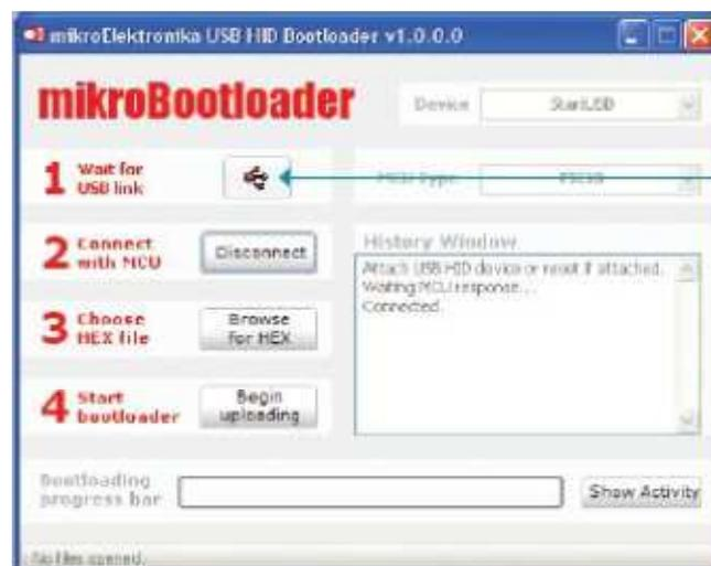
Figura 4.10 El icono USB cambia a color rojo indicando que la conexión se realizó.
