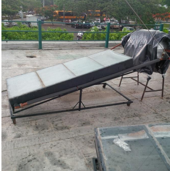
Gráfico 7: Calentador de Agua de bajo costo creado por el Laboratorio de Fuentes de Energía Renovable (ESPOL)
