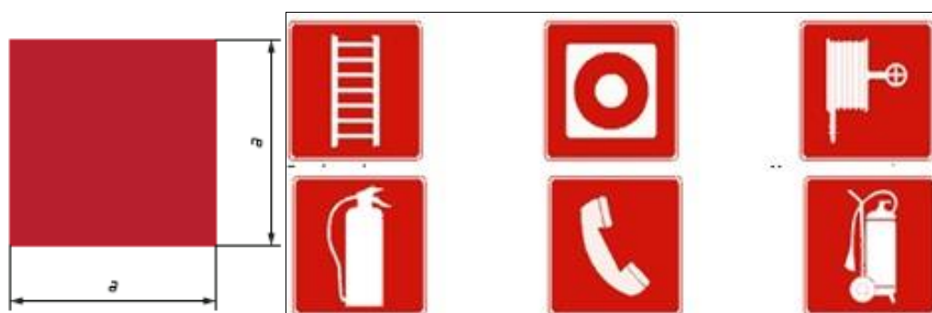
Figura 6.3.7. Señal de Equipo contra incendios.
