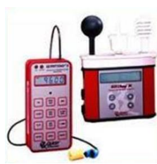
Figura 6.3.16. Medidor de estrés térmico
