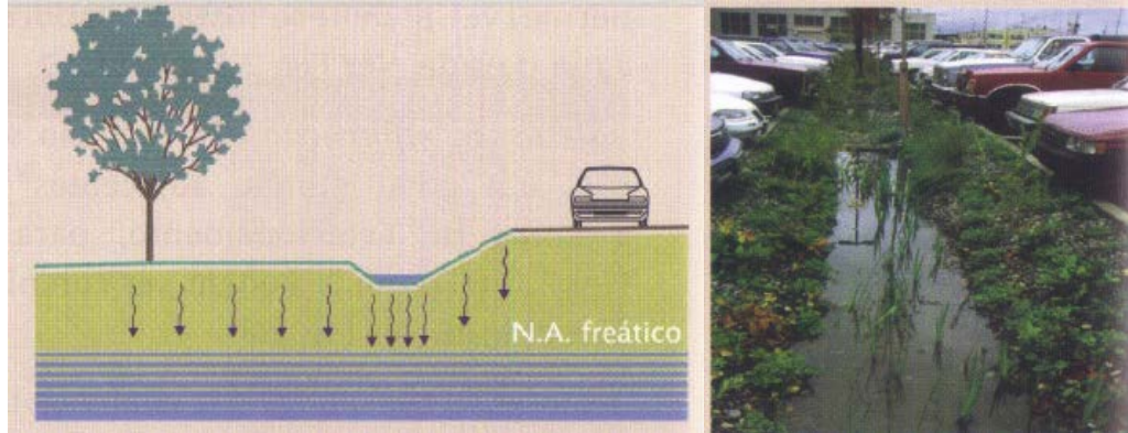
Gráfico 4: Zanjas de infiltración abiertas
