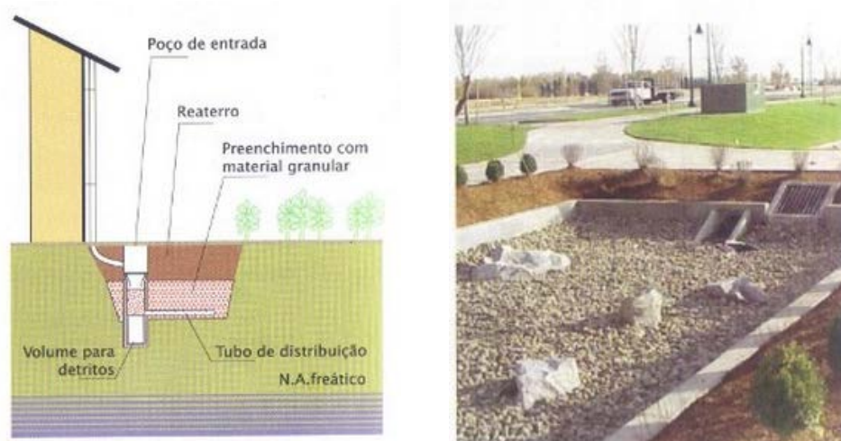
Gráfico 5: Sección transversal e imagen de cuenca de percolación
