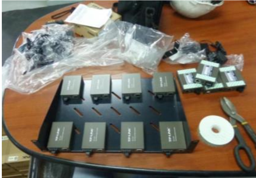
Figura 2.35. Media converter, a instalar en el rack de piso.
