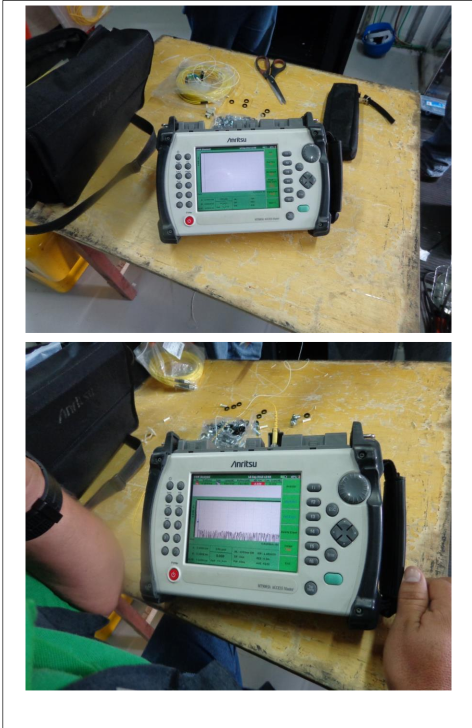
Figura 2.38. OTDR, equipo con el que se hicieron las pruebas
