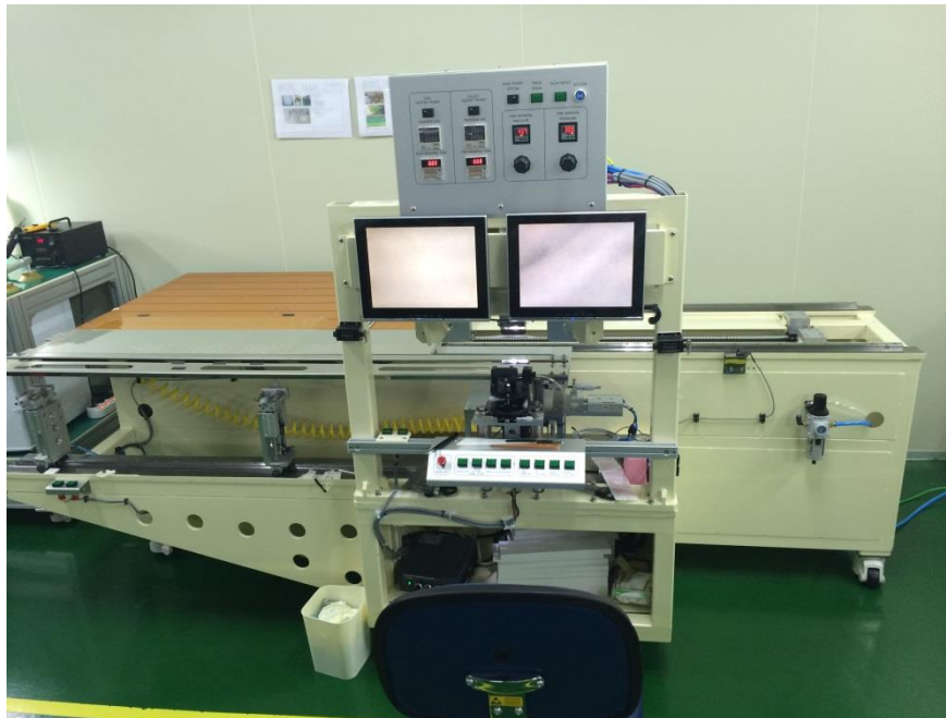
Gráfico 3 – Máquina de Unión de Flexibles por Soldadura Caliente
