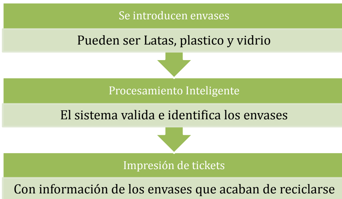
Ilustración 9: Proceso de Reciclaje en Tomra T-UNO Fuente: Tomra T-UNO, 2013 Elaboración: Autor
