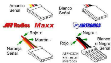
Figura 2.16 Conectores de servos
