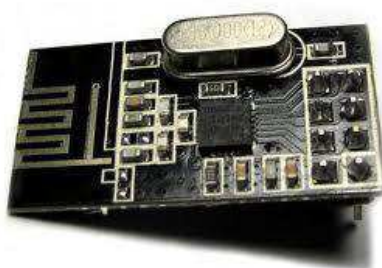
Figura 2.13 Módulo de comunicación inalámbrico por SPI
