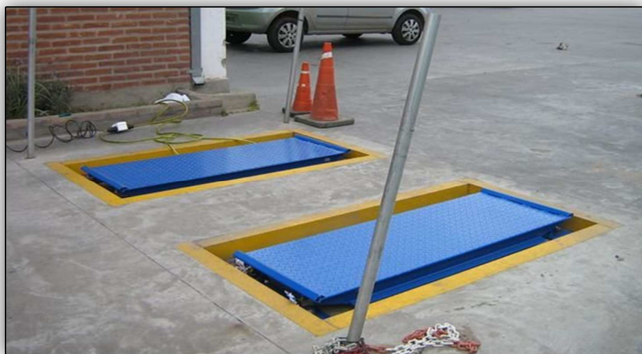
Figura 2.2 Balanza tipo para el peso de eje/vehículo
