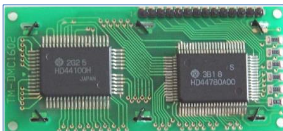
Figura 2.10-2 Vista de reversa de un LCD se observa el controlador HD44100
